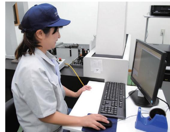
三次元測定機に最新データ処理ソフトウェアを導入。比較的経験の浅い社員でも測定作業ができる。部品ごとの記録を残すことで、顧客への信用度も高まった
