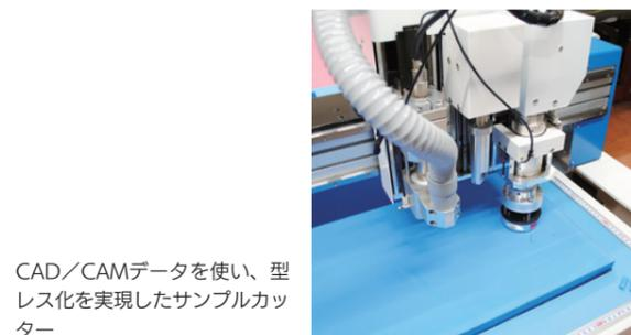
CAD/CAMデータを使い、型レス化を実現したサンプルカッター
