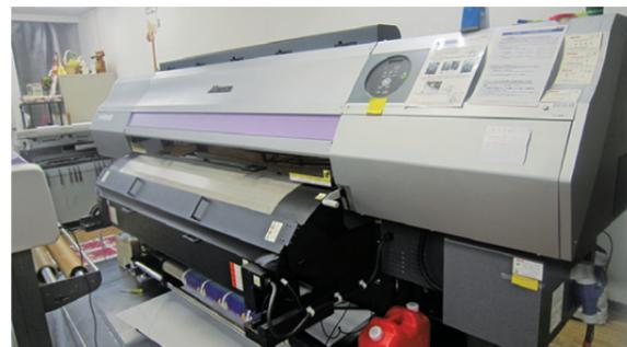
UVインクジェットプリンターは、乾燥時間が必要ないので、すぐに納品できる。イメージに合わせて印刷する素材を選びプリントする
