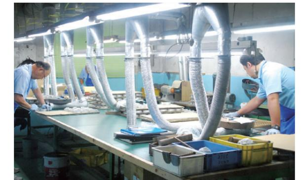
マグネシウムの磨き加工の様子。現在、航空機部品受注を目指し、磨きから機械加工まで一貫生産が可能な体制の確立を目指している
