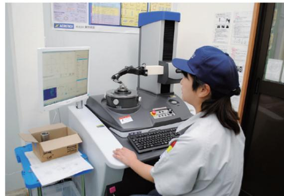
テーブル回転型真円度測定機。測定物が回転し、測定子によって真円度を測定する
