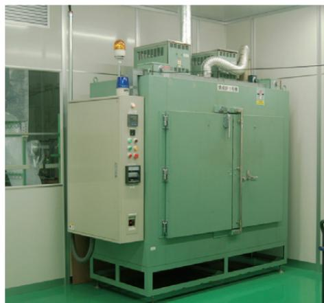
コーティングの焼成炉。トライ＆エラーを繰り返し、最適な焼成条件を確立した
