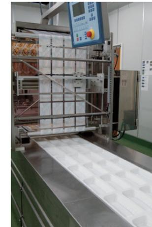
炭酸ガス入り窒素ガス全自動深絞真空包装機の導入により、空気を抜いて炭酸ガス入り窒素ガスを充填しながら焼き魚を包装。酸化や腐敗などを防止し、長期間保存できる
