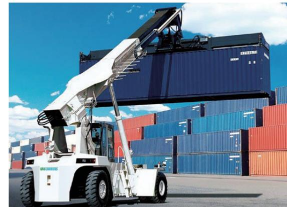
コンテナの積み降ろしや移動運搬を行う大型荷役機械「リーチスタッカー」
