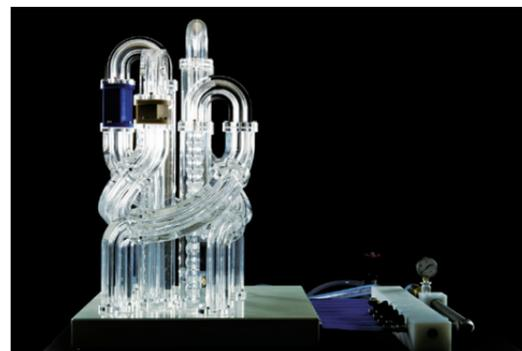
可視化流体試験装置デモ機。各パーツのつなぎ目部分に測定器具を設置することも可能。可視化、耐圧、耐薬品、温度、ひずみ、圧力、流量、電気制御などのあらゆる試験に対応できる試験装置の製作において、設計から設置まで請け負う
