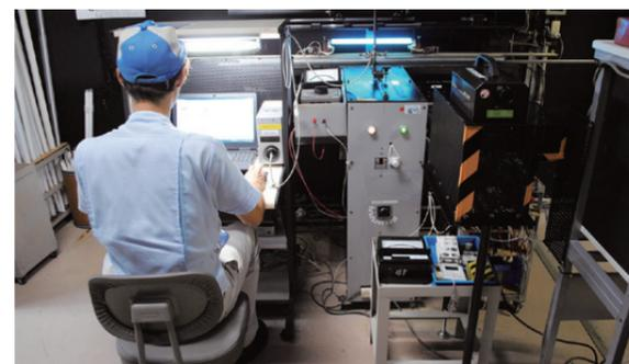
導入した瞬間マルチ測光システム。今まで測定できなかった可視光より短い波長の紫外線を測定できる
