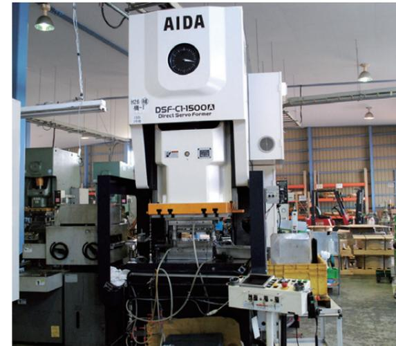
導入したサーボプレス機。加工する際の速度や位置決め、加圧する力などを高精度で制御でき、作業効率が向上
